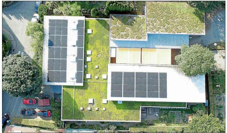
Modulflächen mit insgesamt 220 Quadratmetern Fläche und einer Leistung von 43 KWp erzeugen auf dem Dach der Grundschule Oberweier Strom. Zur Orientierung: links im Bild ist die Bergstraße zu sehen. (Foto: Stadtbau Ettlingen GmbH)
