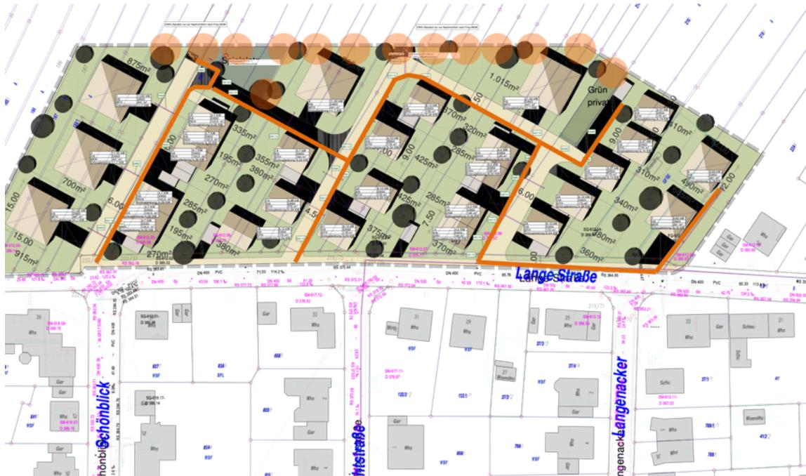
Abbildung 3: Lageplan der Quellenanlage und des Wärmenetzes, Stand 23.05.22 (© Bild: Modus Consult, Bearbeitung durch IB Reiter)
